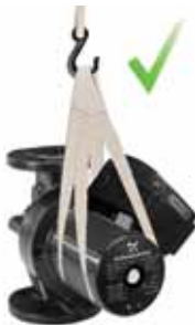
Рис. 7 Правильний спосіб підйому насоса
