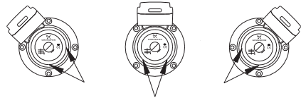
Рис. 5 Расположение клеммной коробки у одинарных насосов
