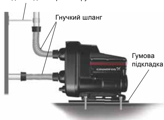
Рис. 4 Зменшення шуму в установці
