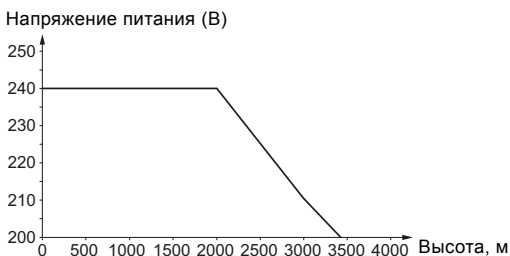
Рис. 35 Напряжение питания для однофазного электродвигателя в зависимости от высоты над уровнем моря
