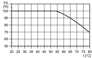
Рис. 13 Зниження потужності в залежності від температури навколишнього середовища
